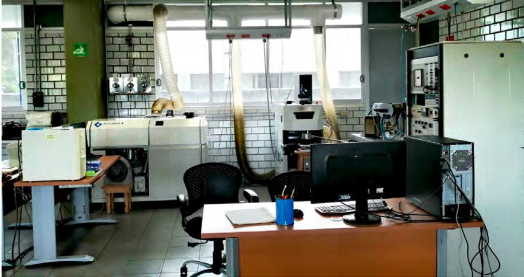
**Figura 4.11:** Equipo de LA-ICP-MS ubicado en el LANGEM del Instituto de Geología de la UNAM.
