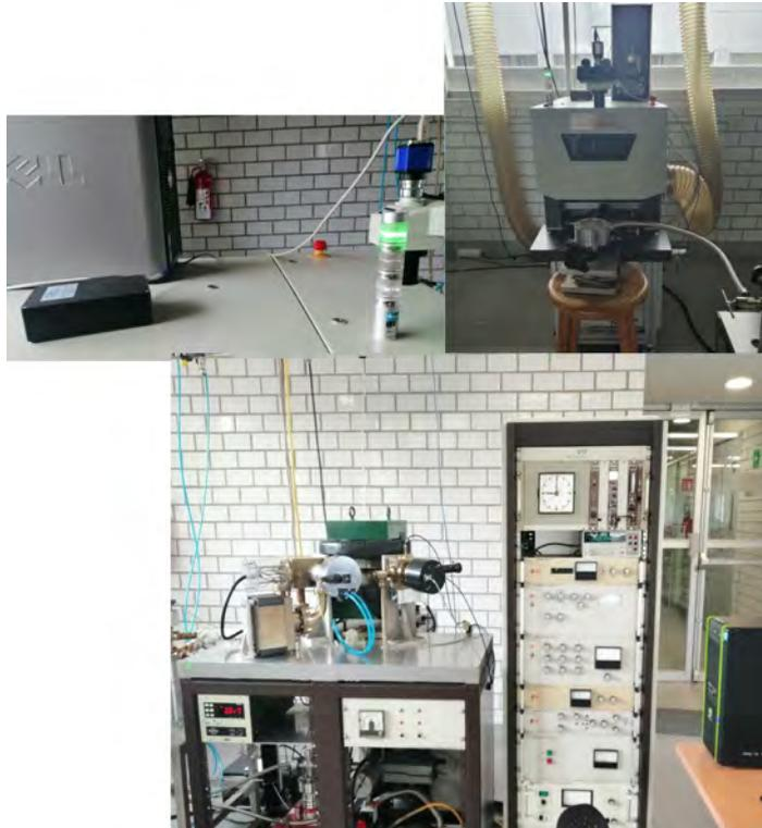
**Figura 4.12:** Equipo LIBS ubicado en el LANGEM del Instituto de Geología de la UNAM. En la parte superior izquierda se muestra el espectrógrafo, del lado derecho se encuentra el láser y el equipo en donde se colocan las muestras, mientras que en la parte inferior se observa el espectrómetro de masas.
