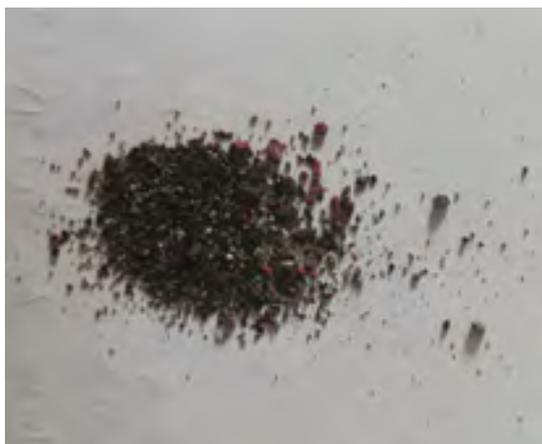
**Figura 4.6:** Muestra del sedimento obtenido con un imán de neodimio en la azotea del Instituto de Geología de la UNAM.
