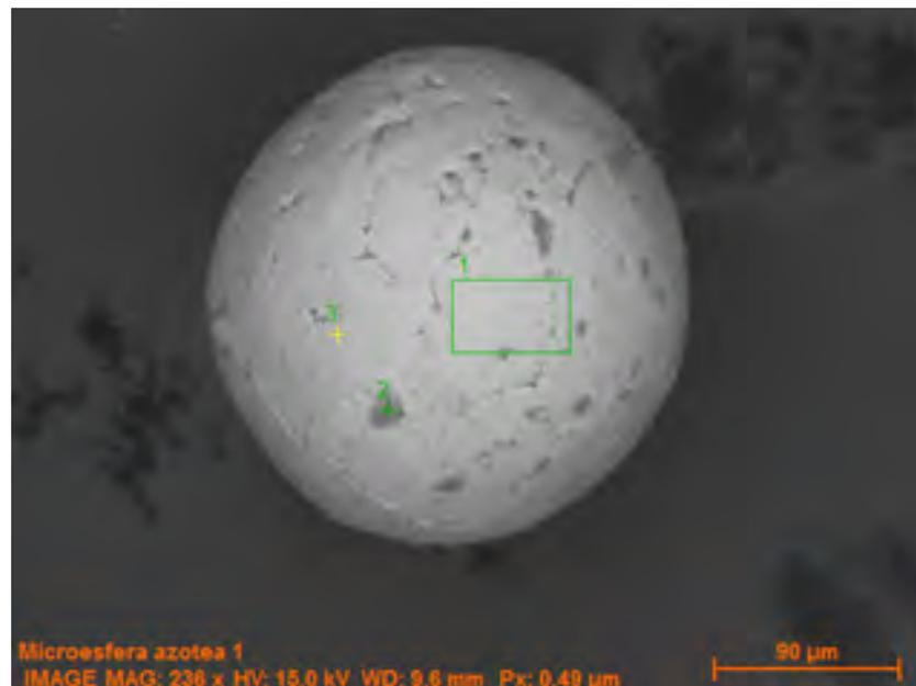
**Figura 5.13:** Imagen obtenida del microscopio electrónico para la microesfera que se encontró en la muestra de caída reciente.
