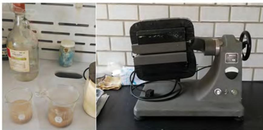
**Figura 4.5:** Del lado izquierdo se muestra el tratamiento que se le hizo a cada muestra de sedimento con el ácido acético glacial y del lado derecho se muestra el Frantz en donde se separó la parte magnética de dicho sedimento.
