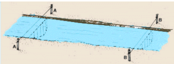
Figura 16. Sección transversal de ambos lados y Figura 17. Velocidad media Fuente: Estimaciones para medir un caudal, FAO. Disponible en < http://www.fao.org/tempref/FI/CDrom/FAO_Training/FAO_Training/General/x6705s/x6705s03.htm > [Consulta: 24 de enero de 2019].
