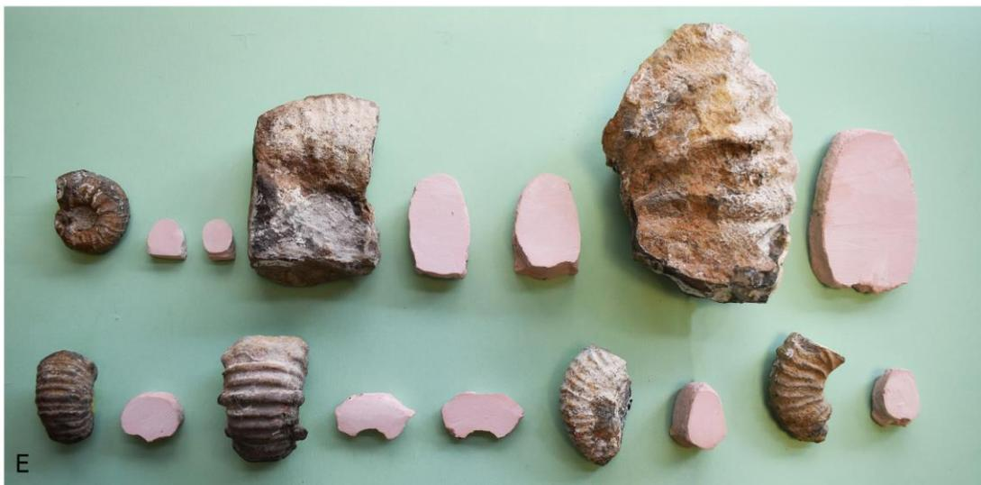
Figura 2. Procedimiento de elaboración de moldes: sellado con plastilina (A), vaciado con yeso (B), cortado del molde (C), limado (D), ammonites de Bella Unión con sus moldes de las secciones de vuelta correspondientes (E).
