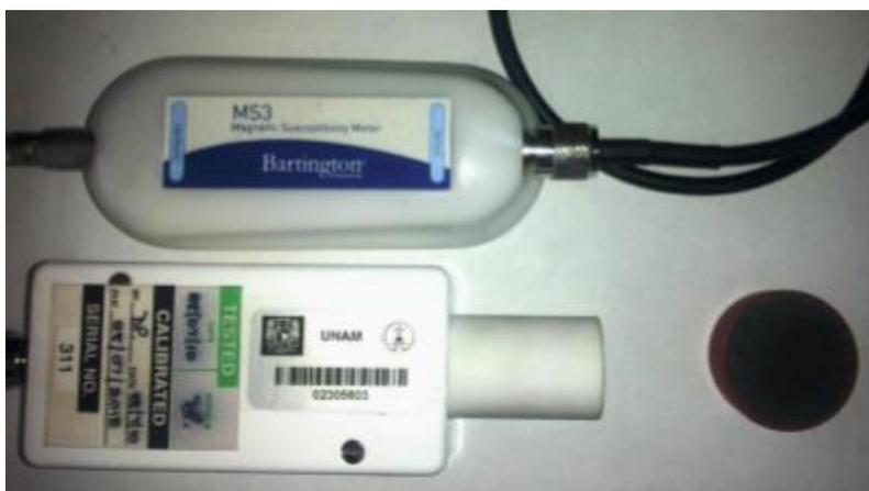
**Figura 12.** Susceptibilímetro Bartington MS3 y sensor MS2E utilizados para el análisis de susceptibilidad magnética de las muestras de sedimentos de este estudio.
