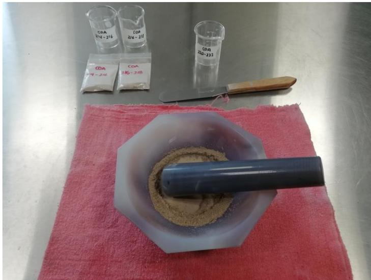
**Figura 11.** Molido de las muestras de los sedimentos colectadas del Lago Coatetelco, estado de Morelos, mediante mortero de ágata.
