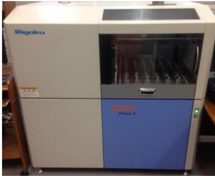
**Figura 15.** Equipo Rigaku ZSX Primus II para el análisis de concentraciones elementales por FRX convencional.
