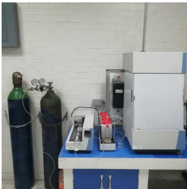
**Figura 13.** Equipo HiperTOC utilizado para el análisis de CT y CIT.
