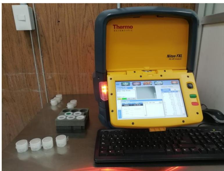
**Figura 14.** Equipo de FRX portátil Niton FXL 950 utilizado para el análisis de concentraciones elementales de las muestras de sedimentos en muestras secas y pulverizadas.
