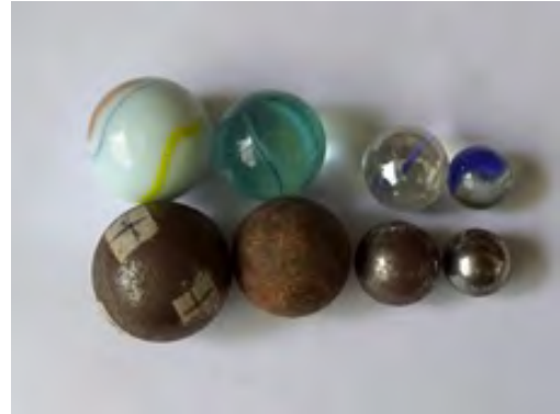
Figura 6.4: Proyectiles: esferas de vidrio y acero usadas en los impactos.
