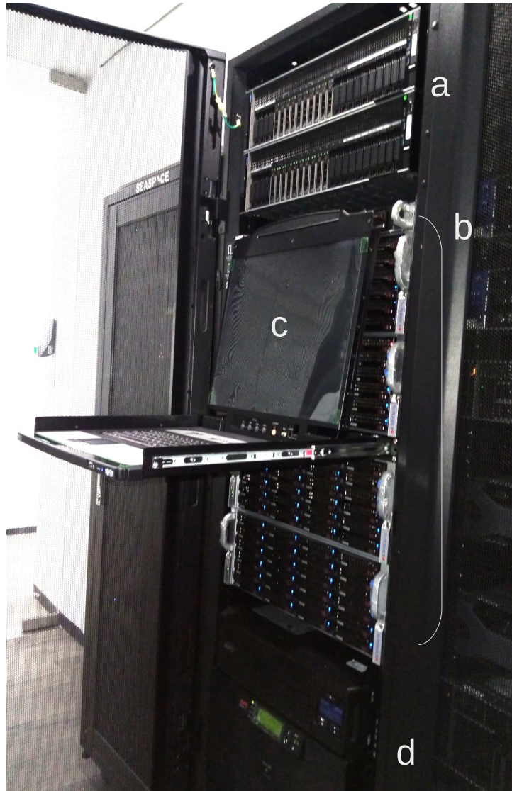
Figura 2.1: Rack con los servidores de procesamiento (a), el sistema de almacenamiento (b), una consola de administración de todos los equipos (c), y los UPS (d).
