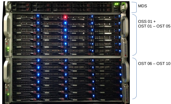
Figura 2.2: El MDS (el servidor 1U de arriba) y un par inteligente y esclavo (JBOD), el OSS alojado en el gabinete 4U de enmedio y los OSTs distribuidos en ambos gabinetes 4U. El foco rojo indica el disco de repuesto en cada gabinete.
