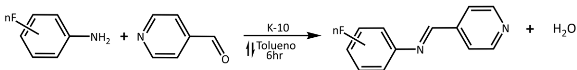
Figura 23. Reacción general para la síntesis de base de Schiff de N-fenil-4'-piridilimina (donde la posición de flúor en el anillo es: 2,3,4; 2,4,5; 2,4,6; 3,4,5 y 2,3,4,6.).
