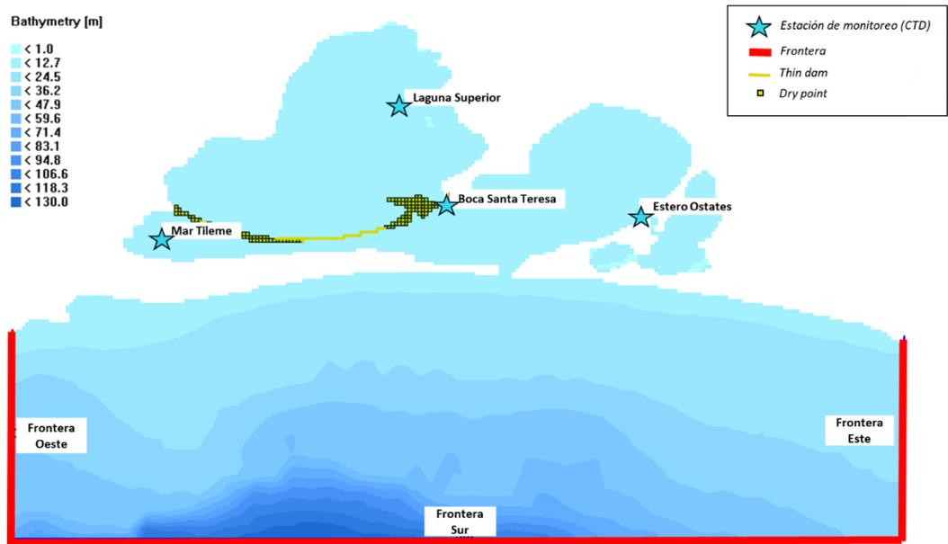
Fig 32. Implementación del modelo, se muestra el dominio, la batimetría utilizada, las celdas secas, las fronteras abiertas en la sección marina y los puntos de observación en las localidades de instalación de CTDs durante los muestreos de campo.
