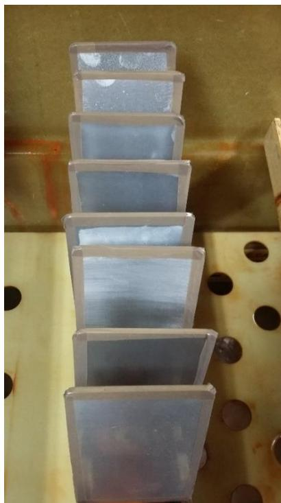
Figura 44. Probetas de aleaciones de aluminio dentro de la cámara salina.
