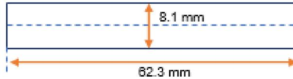
Figura 34. Patrón de medidas para la prueba de flexión
