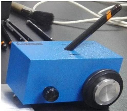
Figura 22. Durómetro (Soporte del lápiz, para realizar la prueba).
