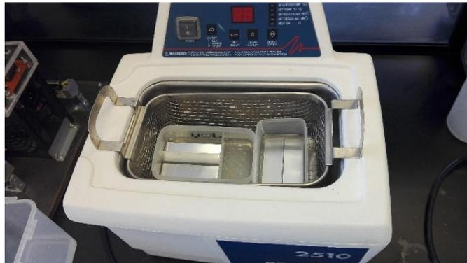
Figura 30. Baño Ultrasónico Marca BRANSON
