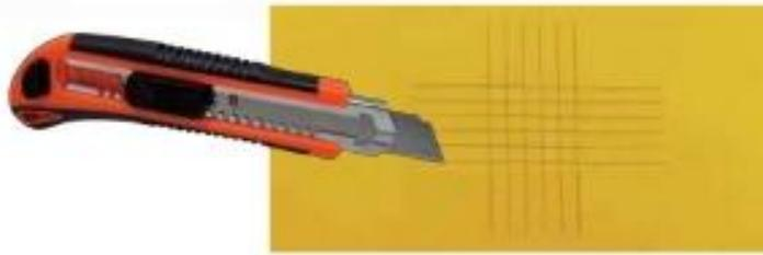
*Figura 38. Representación esquemática de los cortes realizados a los sustratos.*
