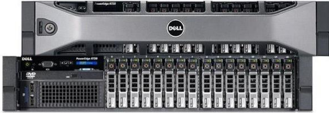
Imagen Núm. 3. Servidor NAS “Dell” con 16 bahías de almacenamiento.
