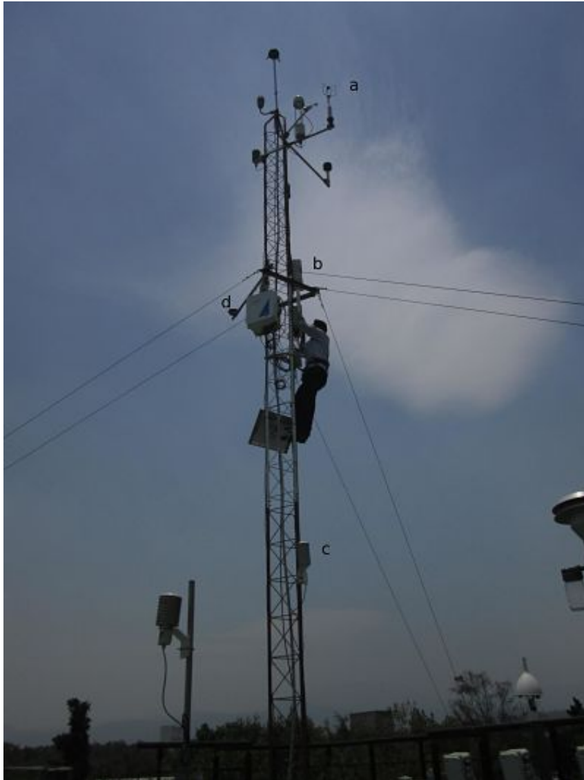
Figura 2.2: Fotografía del equipo en funcionamiento. a) ubicación del anemómetro sónico y el sensor de CO_2 , b) dataloggers, c) el sensor de humedad, d) sensor de la radiación neta.
