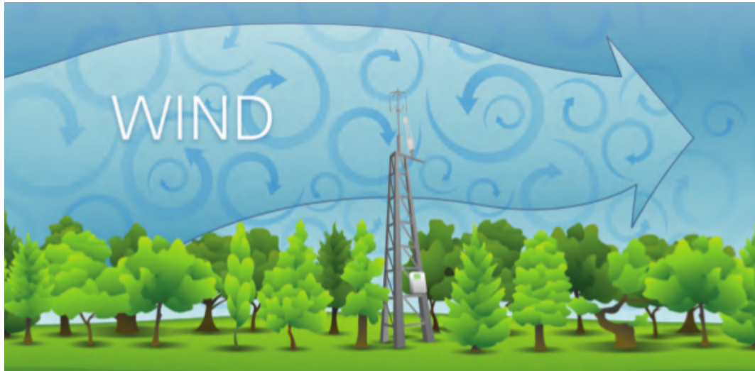
Figura 7.1: Esquema ilustrativo de la torre de flujos, los edies y el viento. Obtenido de (Burba, 2013).
