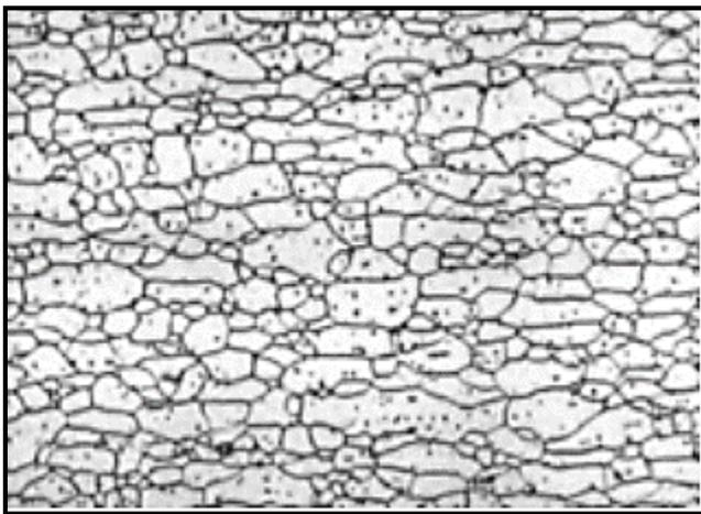
**FIGURA 3:** Tira de acero inoxidable (ferrítico) tipo 430 recocido a 788°C. La estructura consiste en una matriz de ferrita con grano equiaxial y partículas de carburo dispersas.
