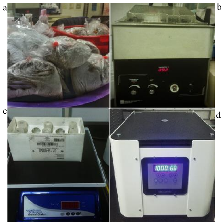
Figura 3. Muestras: Congeladas (a). Baño caliente (b). Agitador (120 rpm) (c). Centrifuga (10000 rpm) (d).
