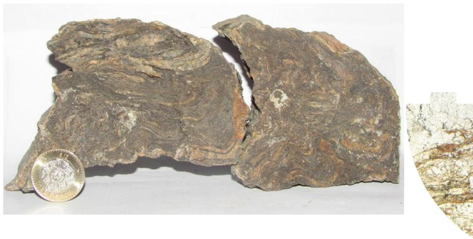
*Figura 7 del anexo (arriba derecha): donde se ve roca 3CA-3. La escala está dada por el diámetro de la circunferencia que equivale a 6mm La muestra está cortada paralelo al rumbo y orientada R/B = 310/52 hacia el NE, mirando hacia el noroeste. mica biotita de color café típico de temperatura media. Además, se observa la gran cantidad de cuarzo de color blanco, los pliegues formados por la biotita y el cuarzo coinciden en la dirección de vergencia.*
