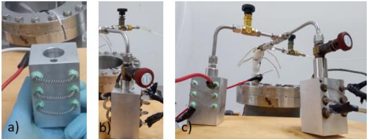
Figura 16. Tuberías y sistema de calentamiento para la introducción de las muestras al sistema: a) el sistema de calentamiento, b) tubería para la introducción de una sola sustancia al sistema y c) tubería para la introducción de dos moléculas al sistema
