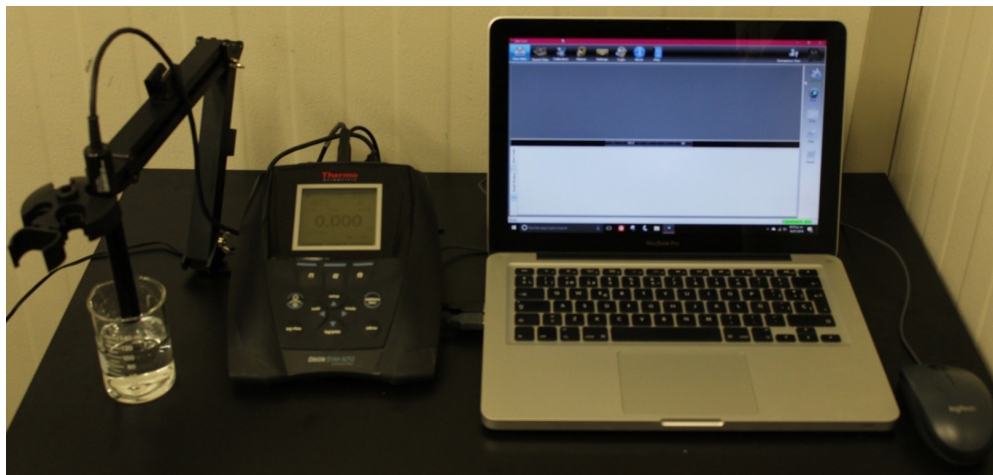
Figura 3.1: Montaje para mediciones de conductividad eléctrica.
