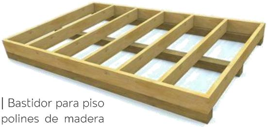
Gráfico 19 | Bastidor para piso a base de polines de madera con un refuerzo intermedio. Fuente: Broissin Arquitectos
