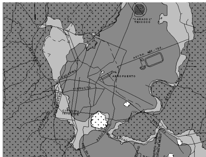
Figura 83. Zonificación geotécnica de la Ciudad de México. Fuente: Reglamento de construcciones para el Distrito Federal, 2007.
