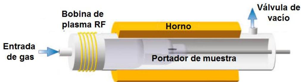
*Figura 7. Arreglo experimental para la síntesis de CNT por depósito químico de vapor [13]*
