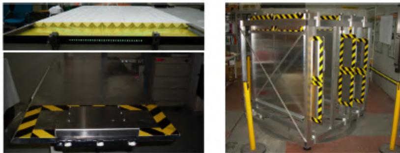
Figura 4.4: MU-RAY Detector, Izquierda: 32 barras de triangulares de plástico centellador y protección de aluminio para la electrónica. Derecha: los 12 módulos que conforman los 3 planos del detector[37]
