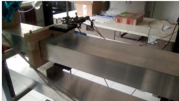
Figura 4.27: Telescopio centellador acoplado en el módulo muon-trazador
