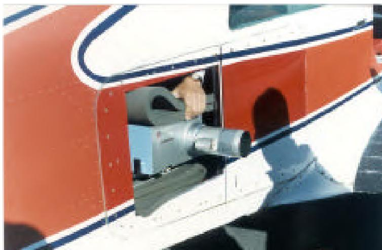
Figura 1.7: Montaje de espectrógrafo en aeronave[16]
