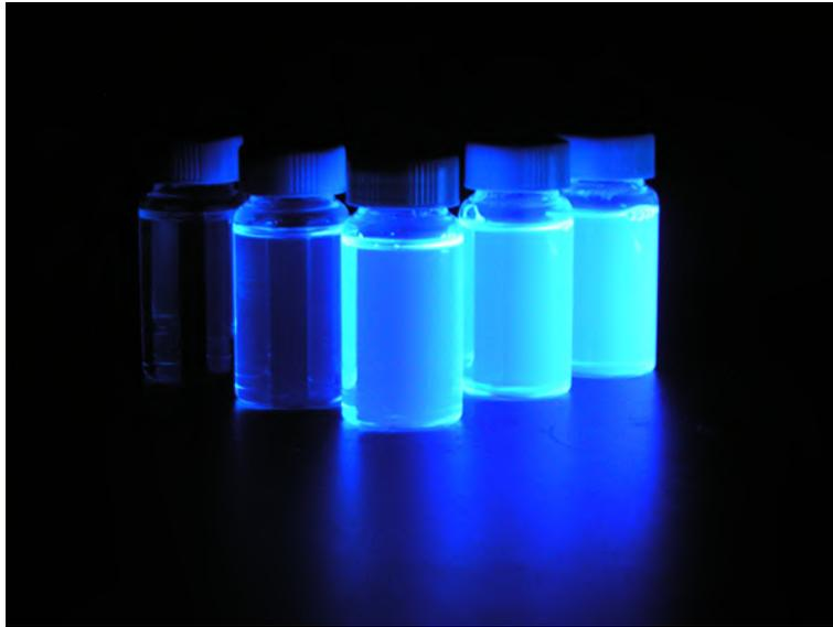
Figura 3.6: Centellador líquido expuesto a luz UV
