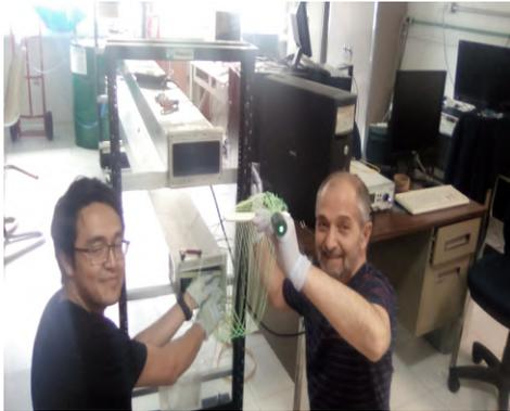
(a) Colocación de las fibras dentro del tubo de aluminio
