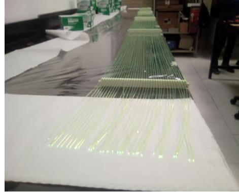
(a) Fibras fijadas en los extremos para aplicar tensión (b) Fibras ya pegadas en los soportes de PVC
