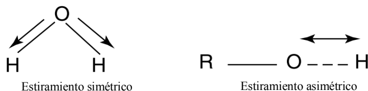
Fig. A2.5. Vibraciones simétricas y asimétricas(imagen tomada de Stuart, 2005).
