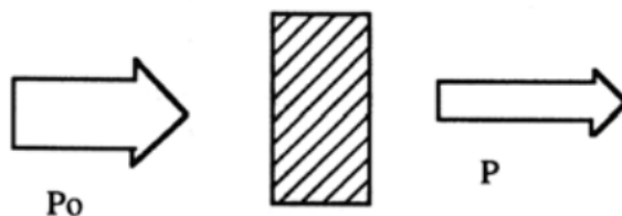
Fig. A1.2 Fenómeno de absorción de radiación por una muestra
