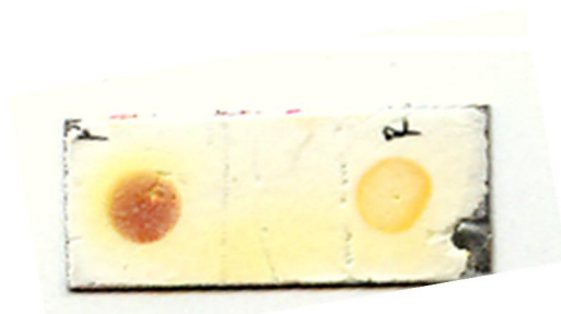
FIGURA 14. REACCIÓN DE NINHIDRINA SOBRE PRODUCTOS (VAINILLILAMINA) Y REACTIVOS (CAPSAICINA) DE LA REACCIÓN DE HIDRÓLISIS.
