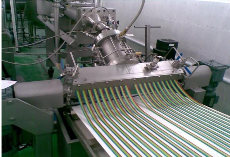
**Figura 24.** Extrusión de caramelos duros (Belt, 2019).
