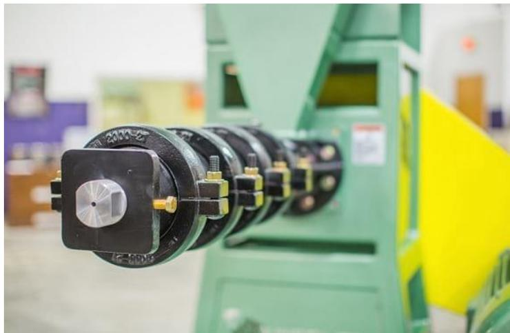
**Figura 9.** Extrusor autógeno (Engormix, 2017).
