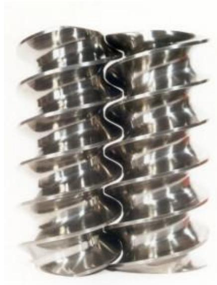
**Figura 12.** Doble tornillo de equipo extrusor (CLEXTRAL, 2019).
