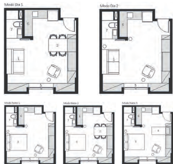
16. Plantas arquitectónicas que muestran las 5 diferentes distribuciones espaciales del departamento, 2 en modo día y 3 en modo noche. Fuente: Archdaily, 2018.
