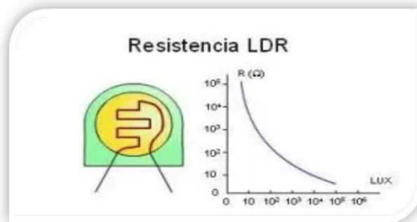
Figura 6: Gráfico que ilustra el comportamiento de la resistencia de una LDR, en función de la intensidad luminosa incidente.
