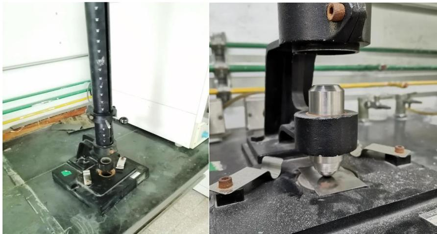
*Figura 5.5 Dispositivo de dureza Shore utilizado para la prueba de embutido.*
