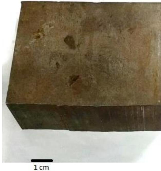
*Figura 5.1 Lingote de acero IF caracterizado.*
