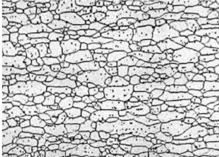
*Figura 4.6 Micrografía de un acero HSLA.*
