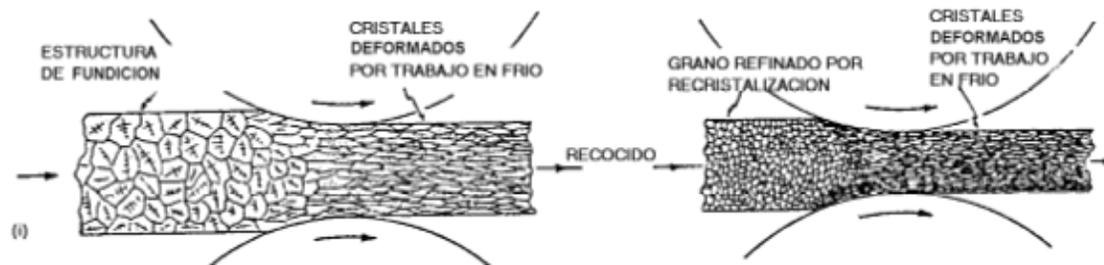
Figura 4.19 Representación gráfica del proceso de laminación en frío.
