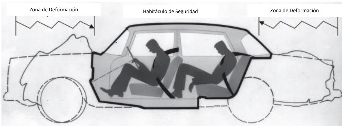
*Figura 4.3 División de diseño de un automóvil donde se observa la zona de deformación y el habitáculo de seguridad*
