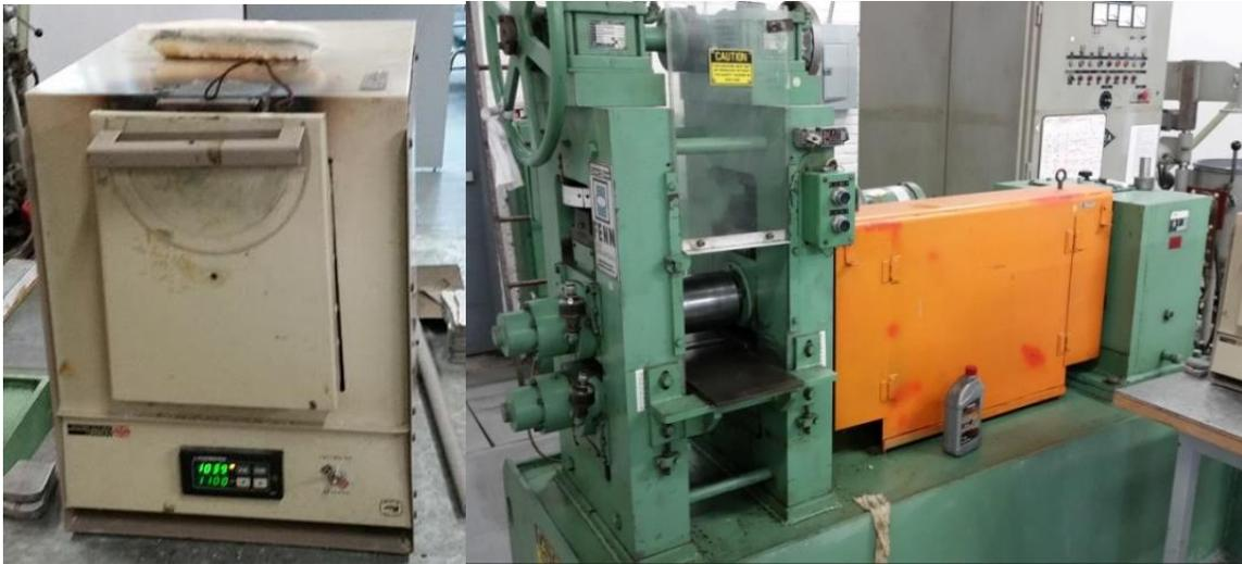
Figura 5.2 Mufla utilizada para calentar el lingote del lado izquierdo y laminador utilizado para la reducción de espesor a la derecha.
