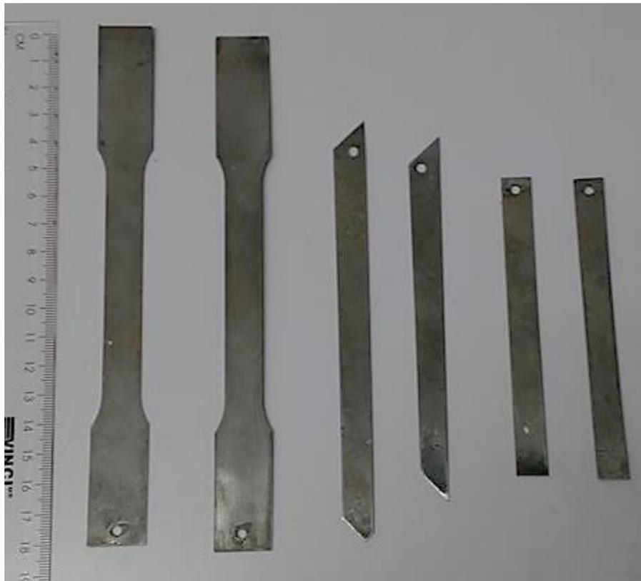
*Figura 5.4 Probetas de tensión de acero IF.*
