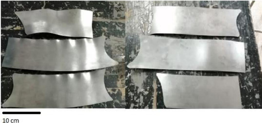
*Figura 5.3 Láminas antes y después del rectificado.*
