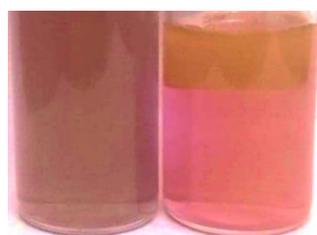
*Figura 3. 13 Coloides de Au-NPs observados antes y después del tratamiento láser con 60 mJ.*
