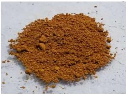
Figura 7. Polvo formado por las NPs de  $YFeO_3$ .
