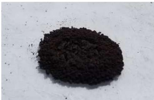
Figura 6. Polvo formado por las NPs de YMnO<sub>3</sub>.
