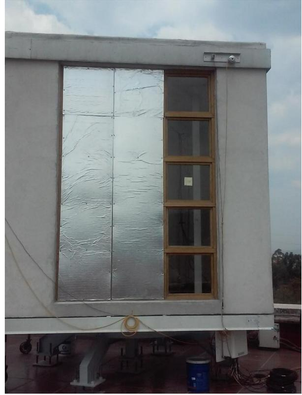
Figura 3- 11/ Configuración de ventana el 35% WWR y el 17.5% WWR
