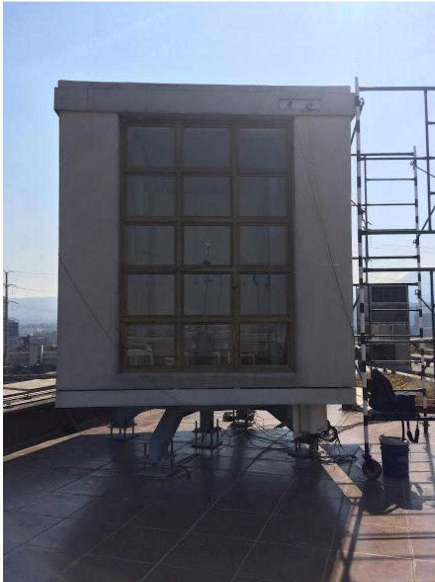
Figura 3-9 / Configuración original de la fachada en el módulo experimental
