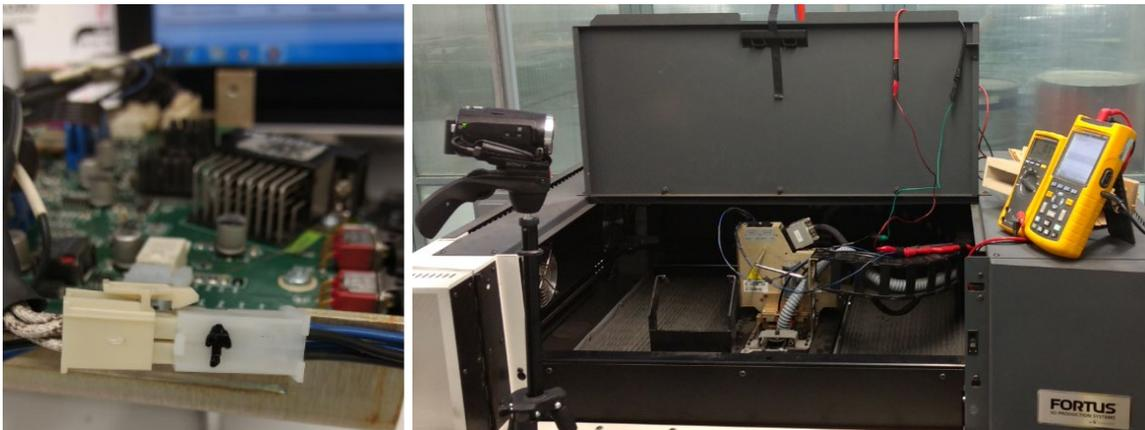
Fig. 21 Instrumentación para la energía de proceso en ME. Izquierda, detalle del conector eléctrico de la boquilla de material de modelo. Derecha, cabezal instrumentado y listo para la medición.
