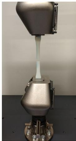
Fig. 19 Ensayo de tensión de las probetas
