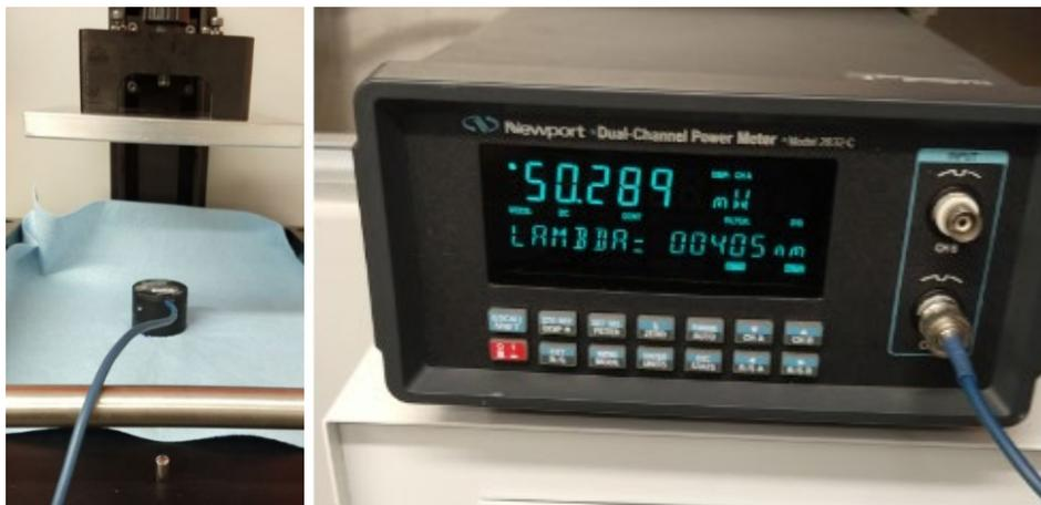
Fig. 25 Medición de la potencia del láser con el sensor (izquierda) y el medidor (derecha).
