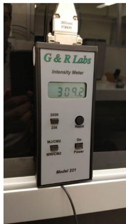
Fig. 28 Radiómetro utilizado para la medición de la exposición de luz UV.
