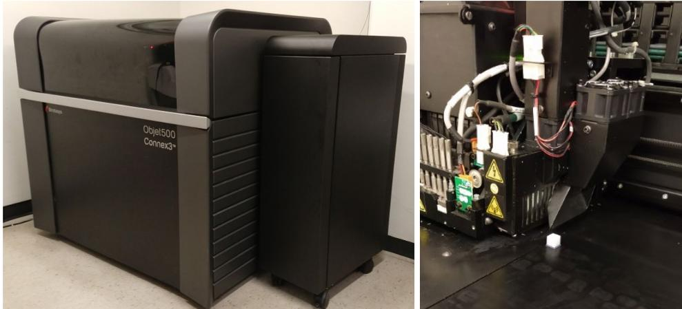
Fig. 27 Máquina empleada para la medición del consumo energético en MJ (izquierda). Detalle del cabezal de rociado de material (derecha).
