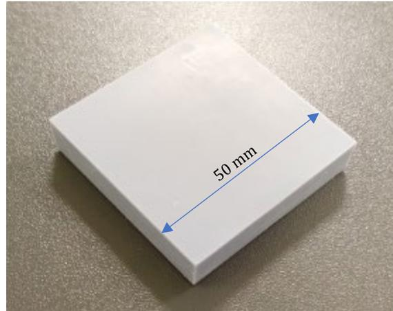
Fig. 26 Espécimen construido mediante el proceso de VP.
