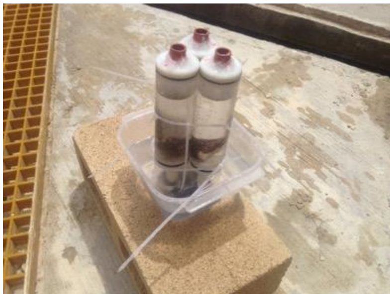
Figura 8. Cámaras de incubación utilizadas para el experimento de fijación de nitrógeno a partir del ensayo de reducción de acetileno.
