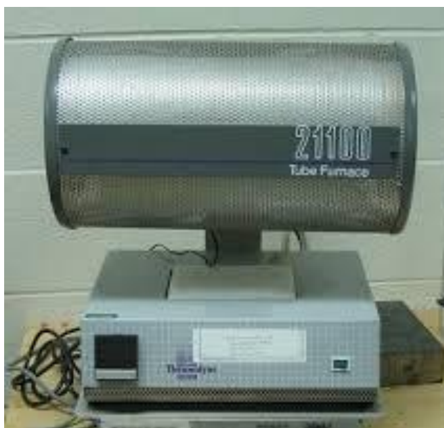
Figura 2.1.1. Mufla Thermolyne 21100 empleada en la síntesis por estado sólido de los compuestos Sr 2 FeMo 1-x Nb x O 6 con flujo de Ar/H 2 .
