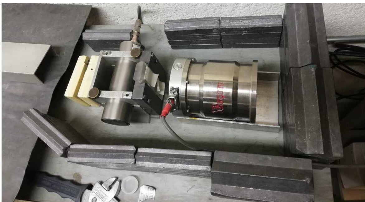
Figura 2.5.3. Espectrómetro de aceleración constante, con una fuente de ^{57}\text{Co} en una matriz de Rodio aislado con barras de plomo, ubicado en la Facultad de Ciencias - UNAM.
