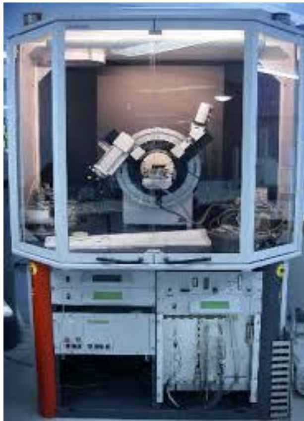
Figura 2.2.2. Equipo de DRX Bruker D8 Advance, el cual cuenta con un ánodo de Cu.
