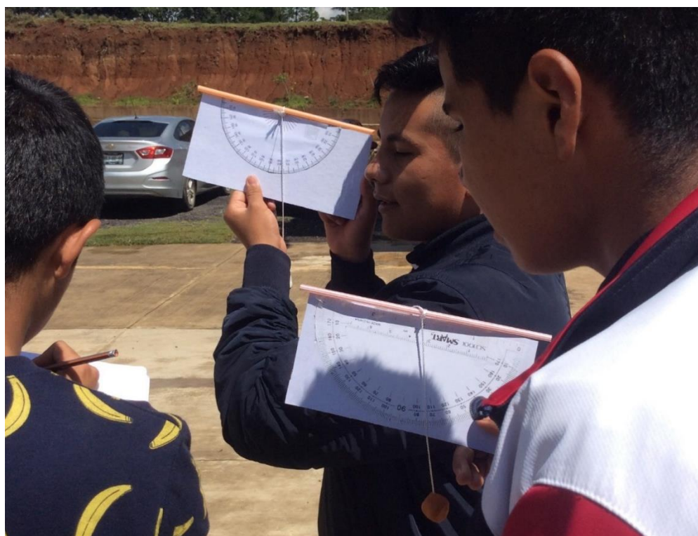
Figura 20. Los estudiantes prueban sus astrolabios en equipos. Unos miden la altura de algún objeto elegido y otros toman el registro de la medición del aparato en grados, para después hacer los cálculos correspondientes.
