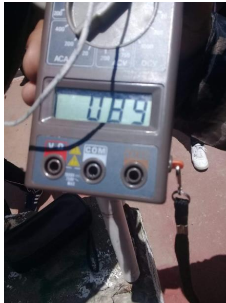
Figura 61. Se muestra la medición de la temperatura en el foco de la estufa y en un radio de 10 cm a partir del foco, al realizar las pruebas de los prototipos.
