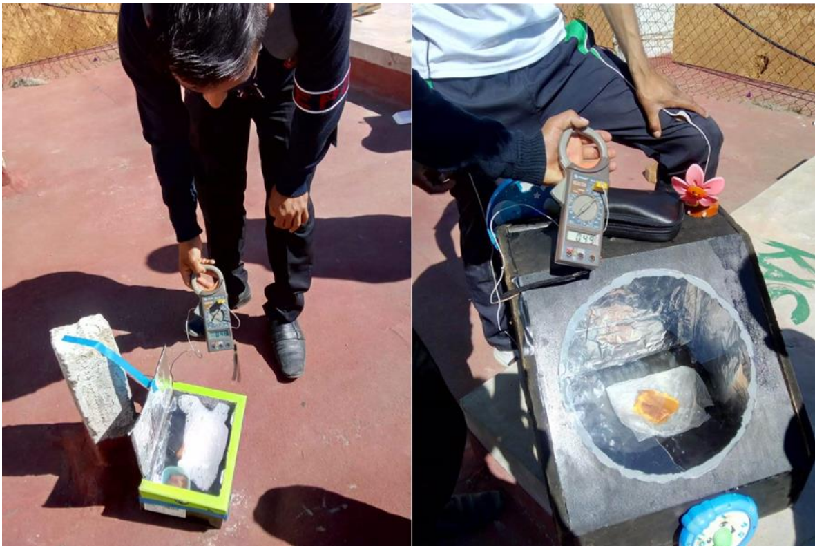
Figura 45. Se midió con un multímetro digital la temperatura del interior de los hornos, en la foto de la izquierda el multímetro mostraba una lectura de 43 °C y en el horno de la derecha el registro de temperatura fue de 49 °C.
