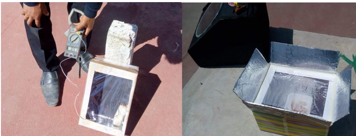
Figura 46. En la foto de la izquierda la temperatura registrada en el multímetro fue de 51 °C, en la foto de la derecha se puede observar cómo se empañaba el hule cristal. Esto indicaba que se estaba llevando a cabo el efecto invernadero dentro del horno y estaba funcionando correctamente.
