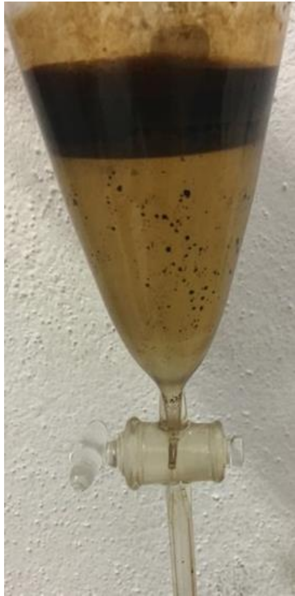
Ilustración 3.6.- Muestra con desemulsificante después de 24 horas de reposo
