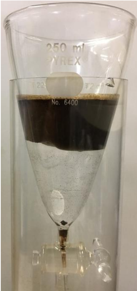
Ilustración 3.5.- Muestra sin desemulsificante después de 24 horas de reposo
