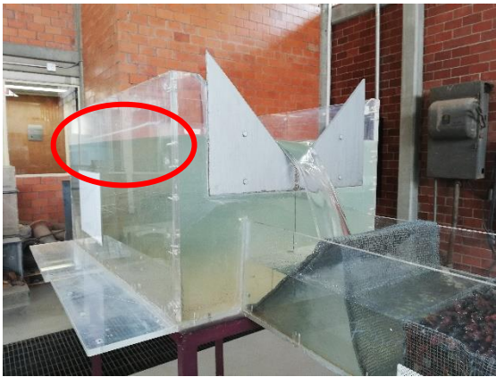
FIGURA 3.2 Tanque con vertedor triangular señalando las etiquetas para la medición de cargas.
