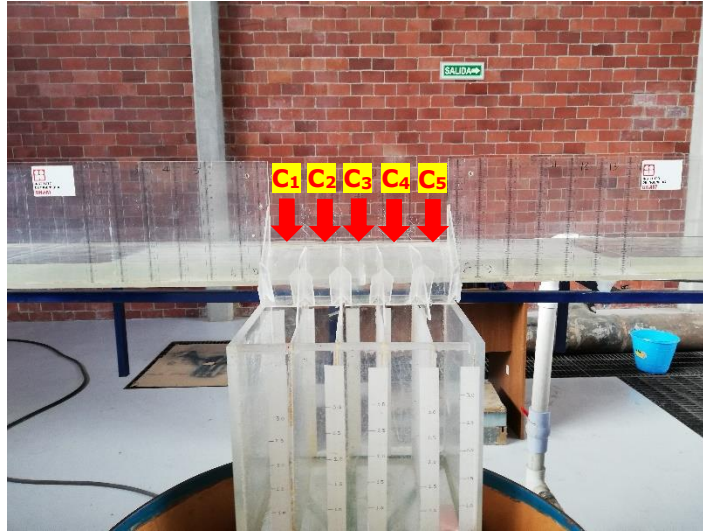
FIGURA 3.17 Depósitos para el aforo de los caudales de desbordamiento, señalando los 5 cimacios donde se realizaron mediciones.
