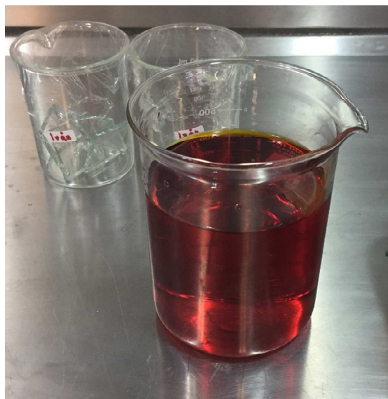
Figura 3.7. FTO en mezcla crómica para su limpieza.
