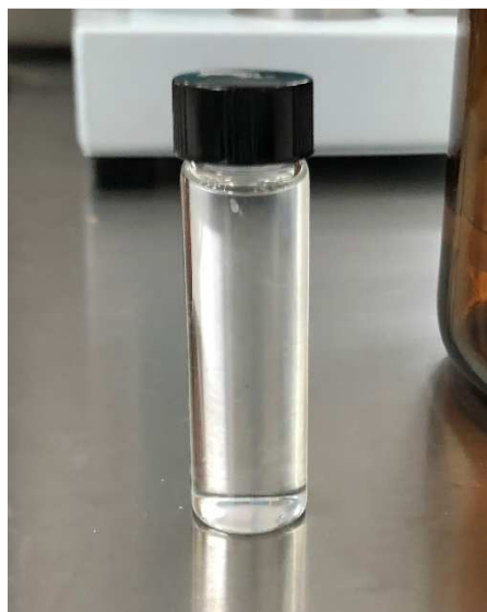
Figura 3.4. Solución de \text{TiO}_2 Mediante sol-gel precursor.
