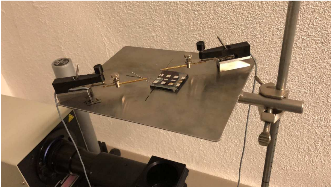
Figura 3.18 Medición de la curva JV en el simulador solar AM1.5.
