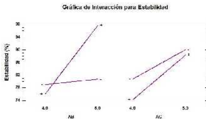
Gráfica 12. Gráfica de Interacción para la estabilidad, cuando se excluye la interacción BC del análisis. A: Phospholipon B: MEG y C: PEG
