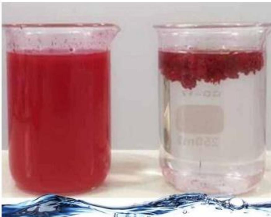
**Imagen 18. Producto coagulante que elimina la viscosidad de la pintura. Foto tomada de la empresa Cleanwater.**
