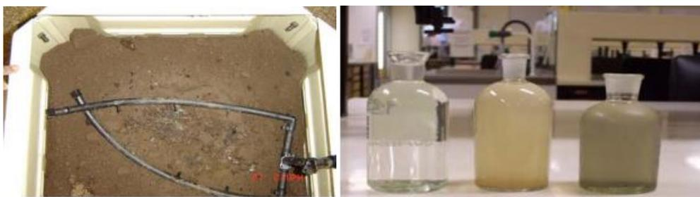
**Imagen 19. Método de vermifiltración.** A la derecha se muestra una cama para la vermifiltración. A la izquierda se muestra la calidad de las aguas generadas después de un proceso de vermifiltración. Foto tomada de artículo “Tratamiento de lodos por vermifiltración con gusanos de tierra: una tecnología sustentable y de bajo costo sobre sistemas convencionales con potencial de descentralización” (Sinha, et. al 2008).
