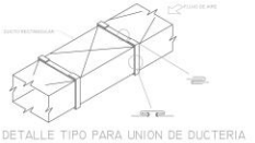
DETALLE TIPO PARA UNION DE DUCTERIA
