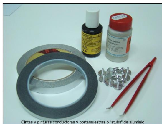
Figura 41. Kit para colocar una muestra en SEM (Cinta de carbón, pintura de grafito y portamuestras de aluminio).
