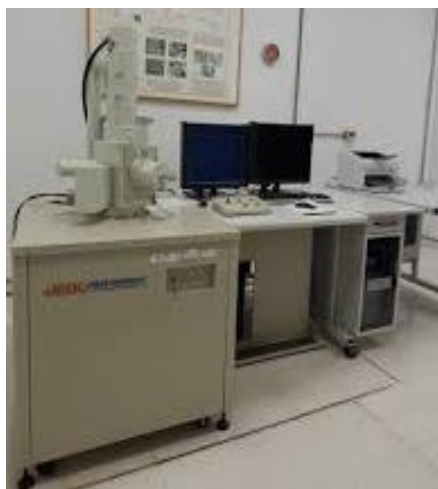
Figura 59. Microscopio electrónico de barrido, JEOL JSM-6060 LV.
