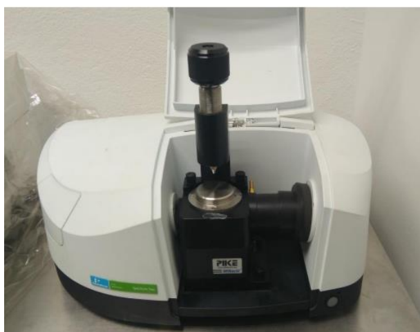
Figura 55. Espectrofotómetro FTIR-ATR, PerkinElmer Spectrum Two.
