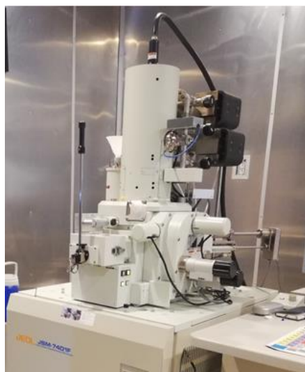
Figura 60. Microscopio electrónico de barrido, JEOL JSM-7401 F.
