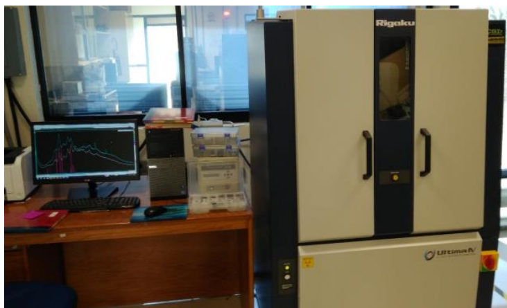
Figura 58. Difractómetro de rayos X, Rigaku Ultima IV.
