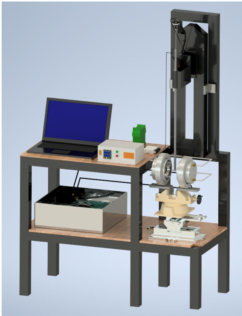
FIGURA 2.1: Diagrama de conjunto del dilatómetro
