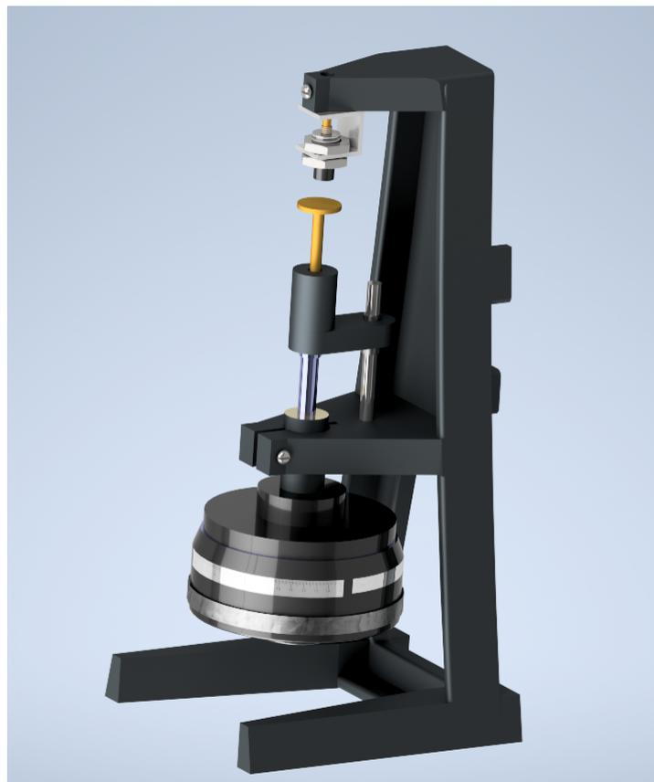
FIGURA 2.3: Montaje en tornillo micrométrico del sensor de corrientes eddy.
