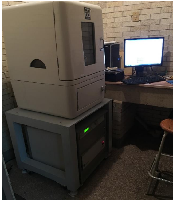
Figura 2.3. Nanoindentador, marca "Hysitron"
