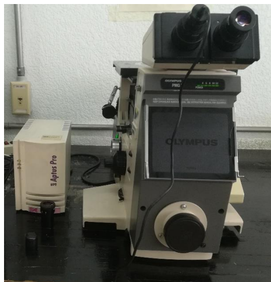
Figura 2.5. Microscopio óptico, marca “Olympus” con cámara
