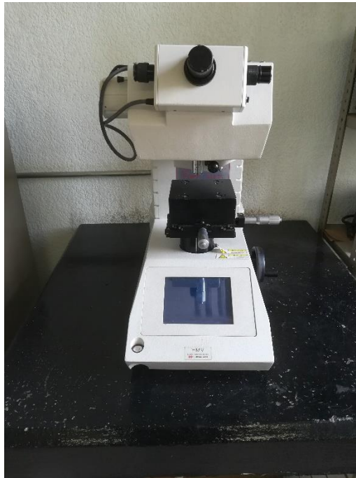
Figura 2.4. Microdurometro marca "Shimadzu"
