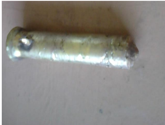
Figura 2.2. Probeta de latón obtenida de colada
