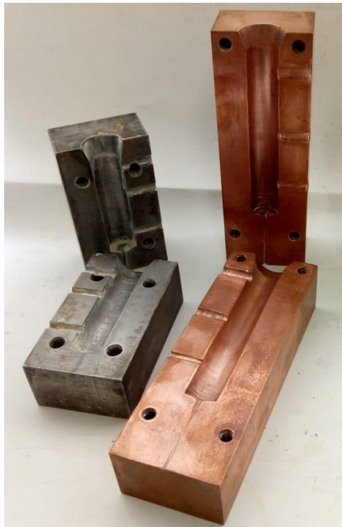
Figura 2.1. Moldes usados para el vaciado.
