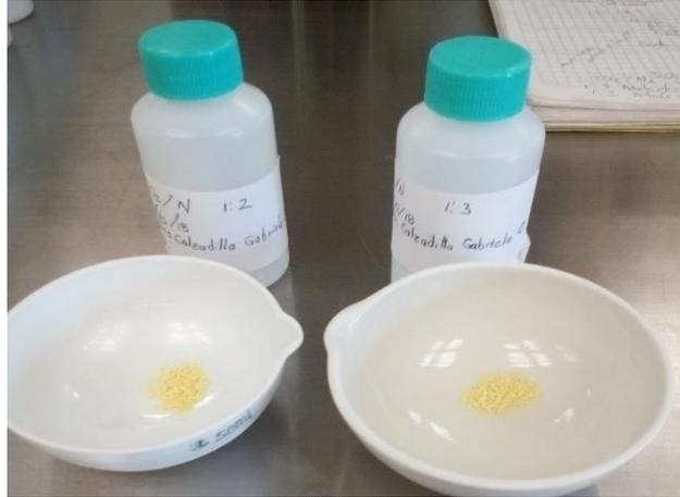
Figura 29. Nanopartículas de  $\text{TiO}_{2x}\text{N}_x$ .
