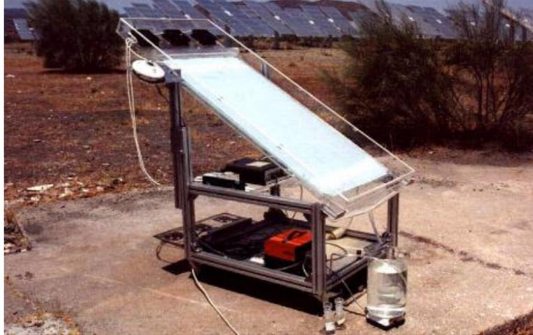
*Figura 19.* Instalación experimental de un colector de placa plana utilizado por el ISFH (Institut für Solarenergieforschung GmbH, Hannover, Alemania) en las instalaciones de la PSA. Tomada de Blanco (2004).
