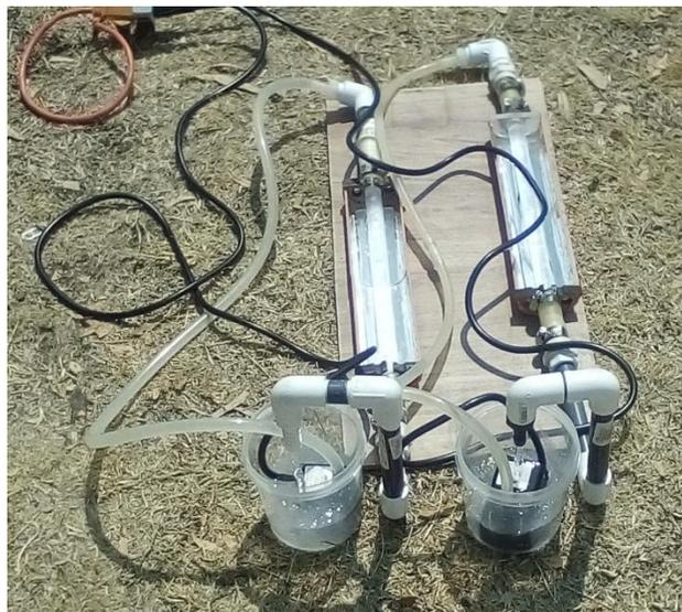
Figura 31. Sistema de reacción para pruebas fotocatalíticas solares.
