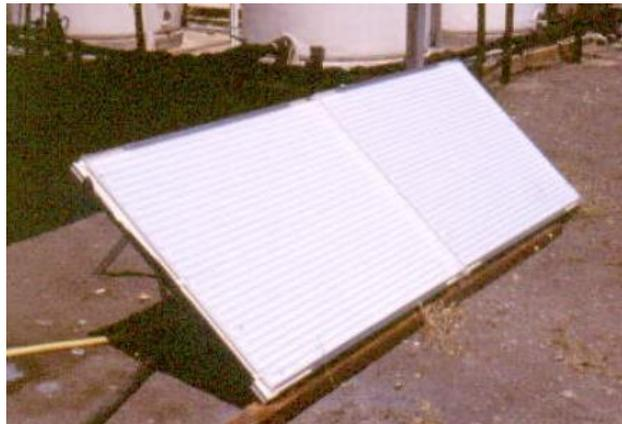
*Figura 20.* Instalación experimental de un colector de placa plana hueca construido a partir de materiales plásticos. Tomada de Blanco (2004).
