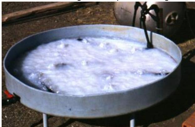
*Figura 22.* Instalación experimental de un colector tipo balsa superficial ensayándose en la Plataforma Solar de Almería (CIEMAT, España). Tomada de Blanco (2004).
