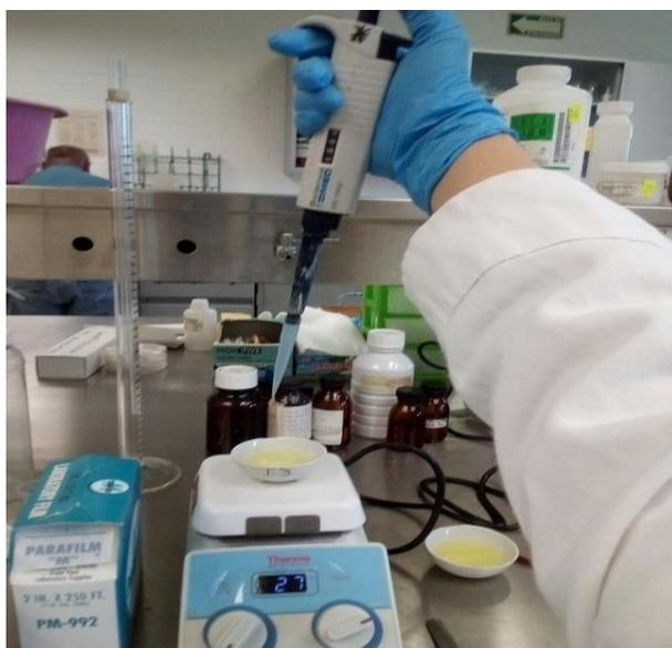
Figura 26. Etapa de hidrólisis y condensación  $\text{TiO}_{2-x}\text{H}$  relación 1:2.
