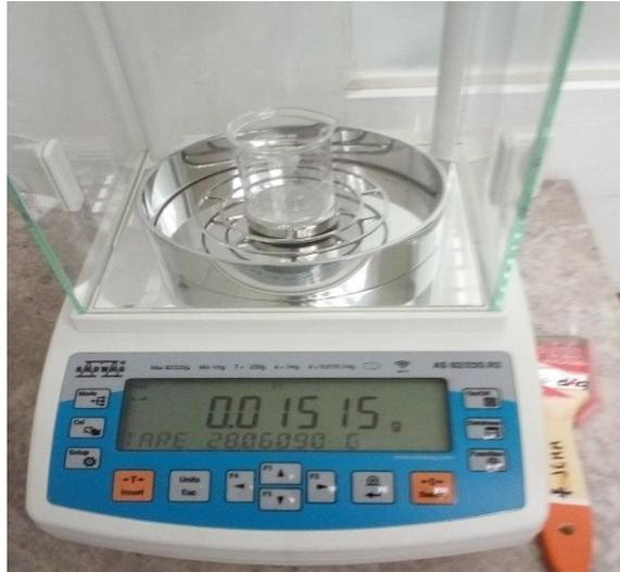
Figura 30. Medición de la masa de Acesulfamo-K.
