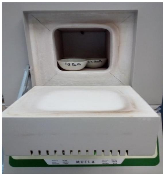
Figura 28. Sinterización nanopartículas  $\text{TiO}_{2-x}\text{H}$  relación 1:3.
