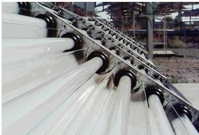
*Figura 24.* Detalle de un colector CPC donde se observa la configuración de los tubos reactores. Tomada de Blanco (2004).
