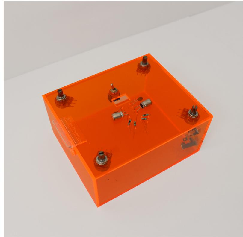
Uno de los bloques del oscilador en construcción.
