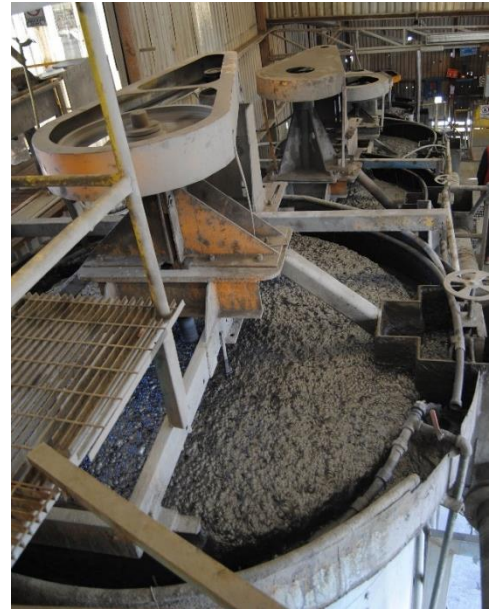
Figuras 1.4 y 1.5. Proceso de flotación en la planta de beneficio de la unidad minera Vetagrande, Zacatecas.
