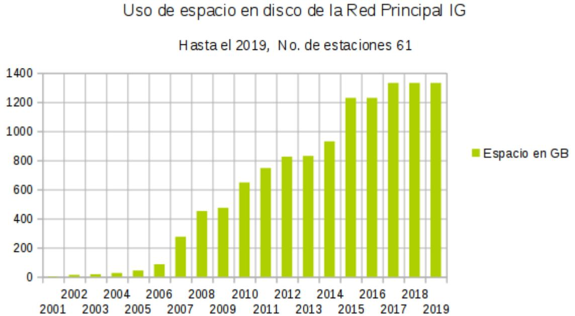
Figura 1.1: Almacenamiento reportado por el SSN del 2001 al 2019. Al 2019, el SSN recibe datos de manera continua de 61 estaciones permanentes, cada una de las cuales registra 6 canales de datos (3 canales de velocidad y 3 de aceleración). Servicio Sismológico Nacional, UNAM; Enero 2020
