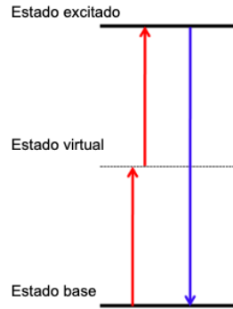
Figura 7.3: Niveles energéticos en el proceso de absorción de dos fotones. [24]
