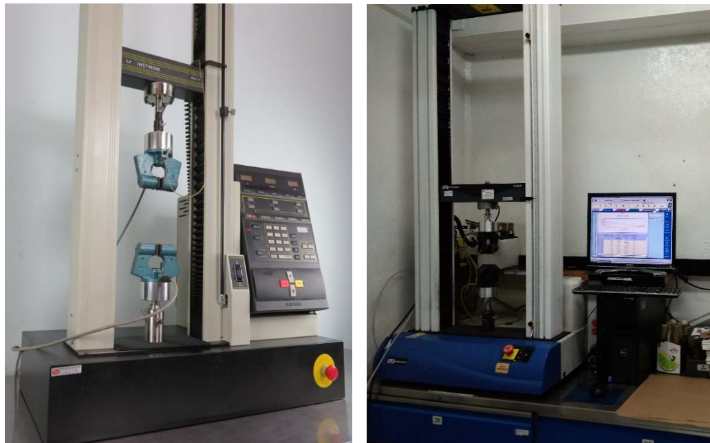
Figura 2.12 Máquina Universal Instron. [26]
