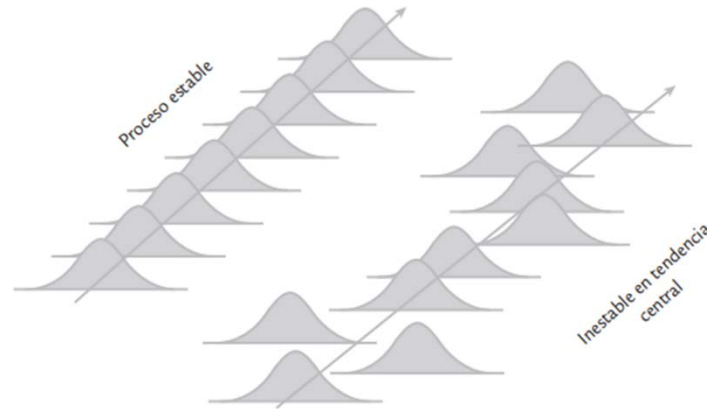
Figura 3.9 La carta \bar{X} detecta cambios significativos en la medida del proceso. Cuando la curva se desplaza la carta manda una o varias señales de fuera de control. [5]
