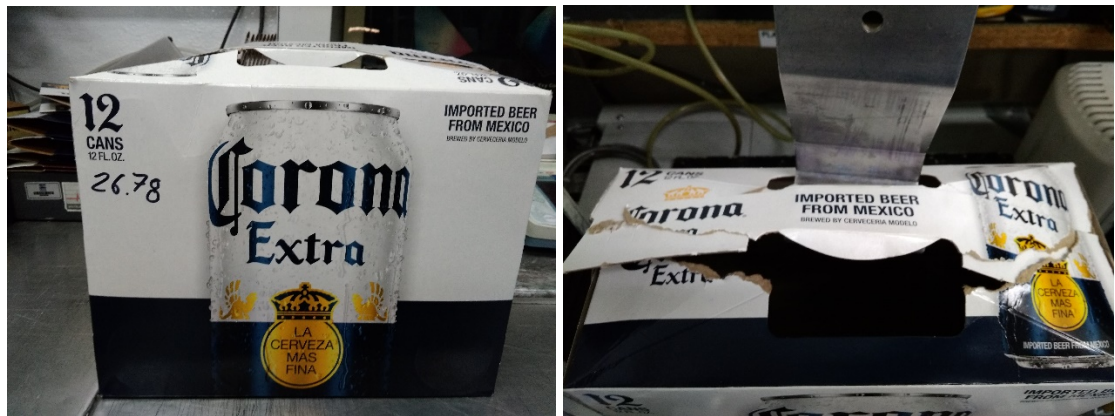
Figura 2.13 Prueba de Integrity Test en una caja fibra. [26]
