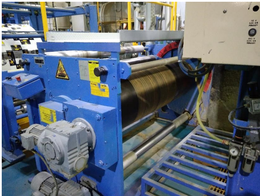
Figura 2.6 Rodillos de máquina laminadora, utilizado para la elaboración del corrugado. [26]
