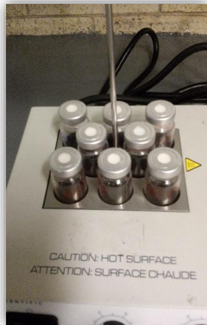
Figura 10. Bloque de calentamiento empleado en las cinéticas en viales.
