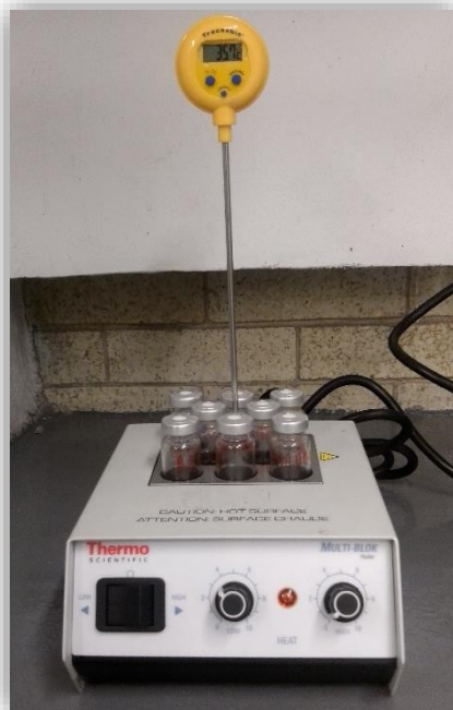
Figura 10. Bloque de calentamiento empleado en las cinéticas en viales.
