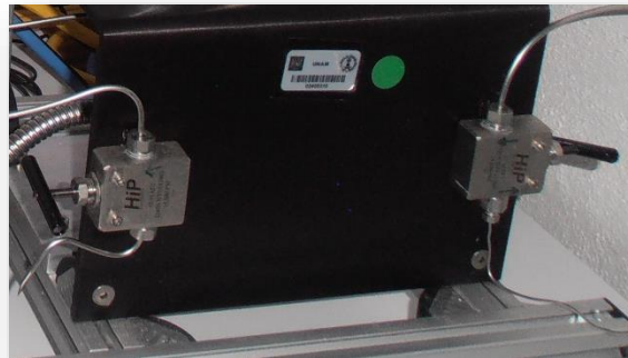
Figura 15. Sistema de reacción para la síntesis de redes poliméricas en fluidos supercríticos. a) Bomba de pistones de alta presión marca ISCO modelo 260D para la alimentación a alta presión del CO 2 hacia el reactor. b) Sistema de reacción empleado de la marca Supercritical Fluid Technologies, Inc. Modelo HPR-Series 1. c) Detalle lateral donde se observa el enchaquetado que calienta al reactor. d) Detalle frontal donde se observan las válvulas de entrada/salida conectadas directamente al vaso del reactor.
