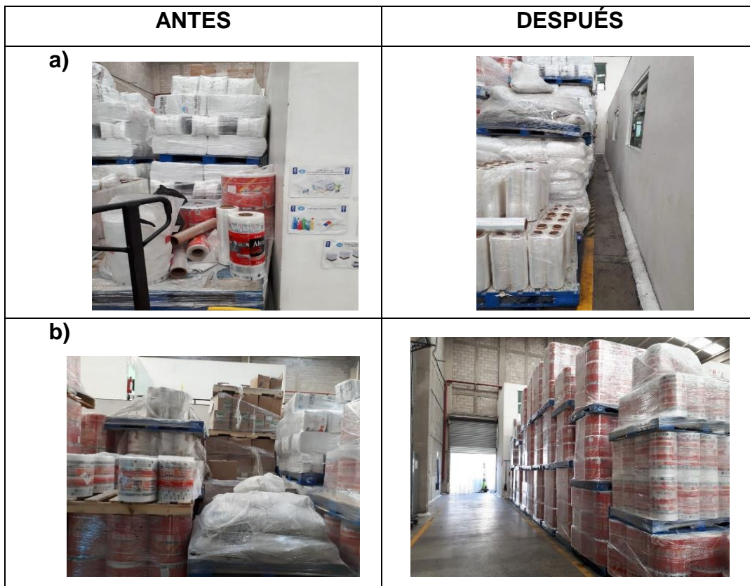
Figura 33. Implementación de 5S en el almacén de materia prima de empaque a) Liberación de franja sanitaria b) Materia ordenado e identificado.
