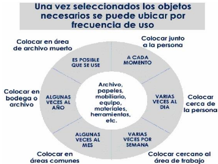
Figura 7. Ubicación de artículos para implementar Seiton (Secretaría de Extensión e Integración Social IPN, 2013).
